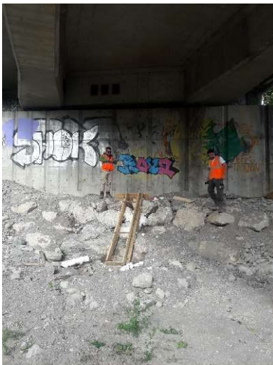
Figure 12 : Emplacement de l'échelle limnimétrique au lieu de référence
